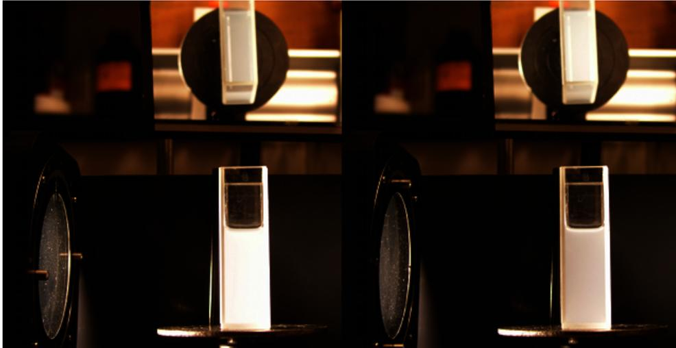
Abb. 2: Die Küvette wird mit vertikal (re.) und horizontal (li.) polarisiertem Licht beleuchtet und mit Hilfe eines Spiegels wird zusätzlich das nach oben gestreute Licht betrachtet.
