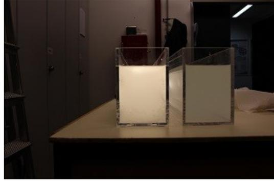
Abb. 5: Links Kuvette mit Milch die vorwiegend Rayleighstreuung zeigt und rechts eine Kuvette mit verrührtem Bariumsulfat.
