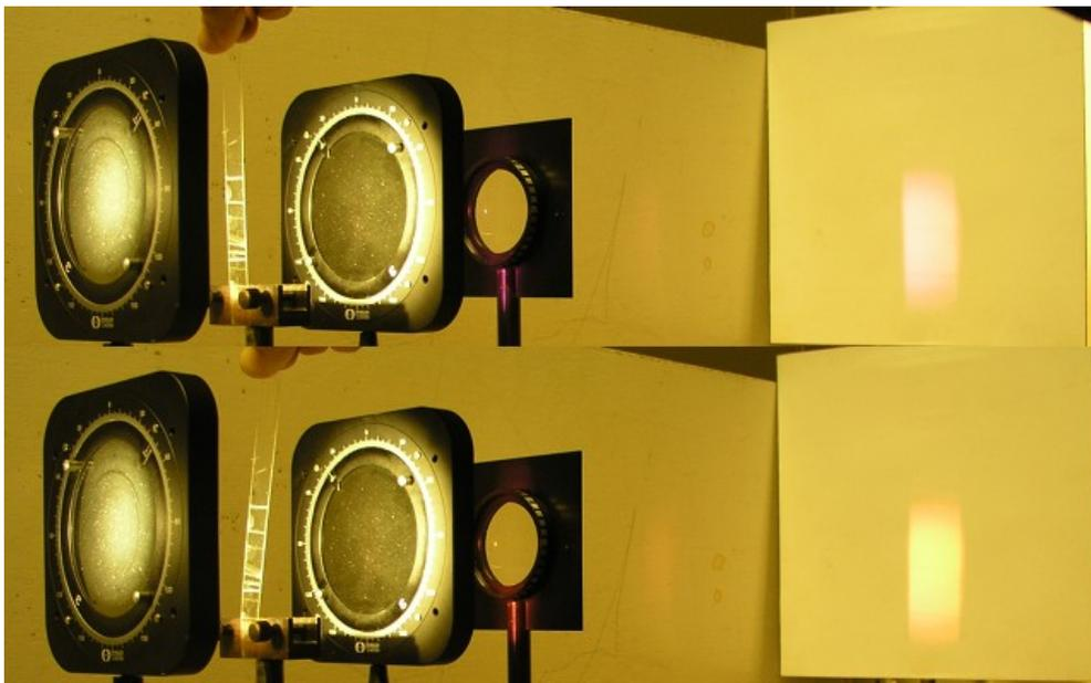
Abb. 4: Einige Tesafilmsorten zeigen doppelbrechenden Charakter, unter Spannung können so Farben variiert werden.
