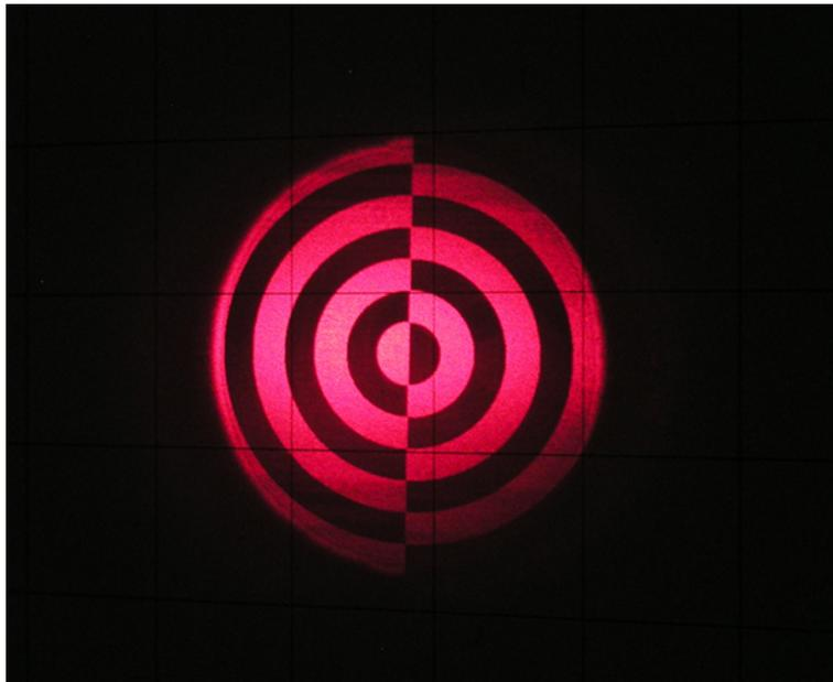
Abb. 2: Mitgelieferte Phasenmaske bei Beleuchtung mit Laserlicht.
