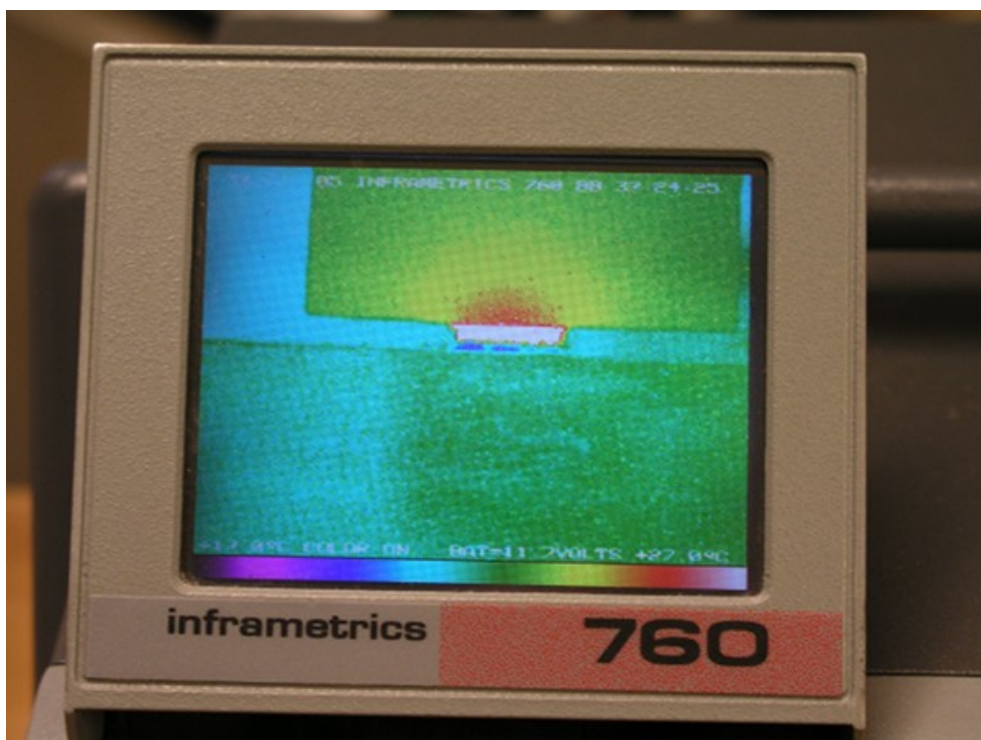
Abb. 3: Falschfarbenbild eines Peltierelements zwischen 2 Metallblöcken
