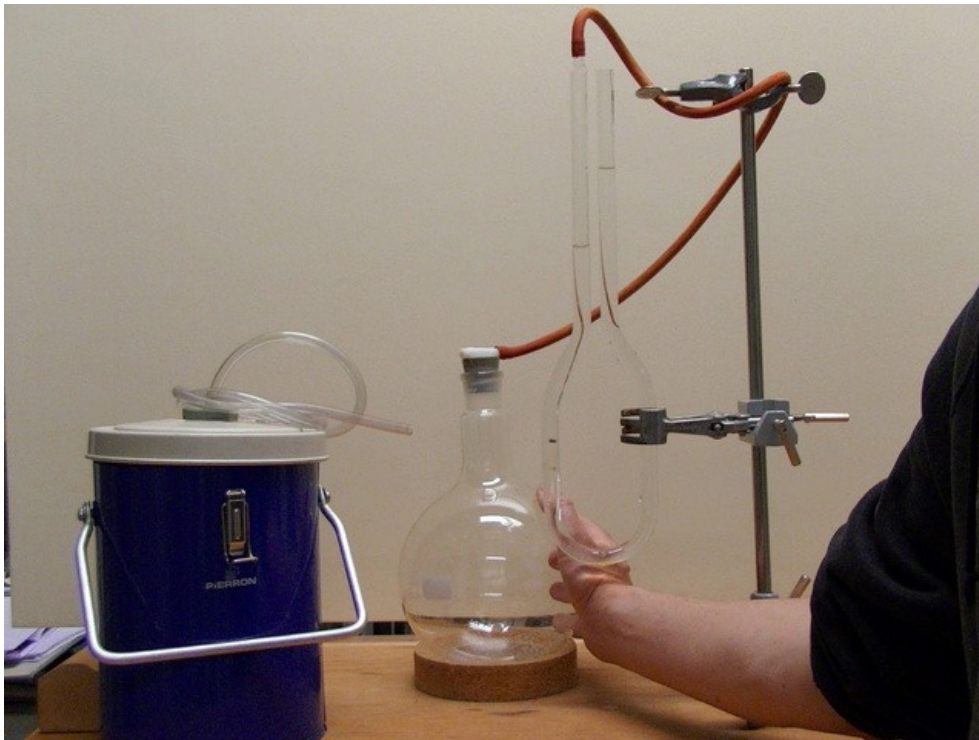
Abb. 2: Handauflegen verändert den Pegelstand im Messrohr.
