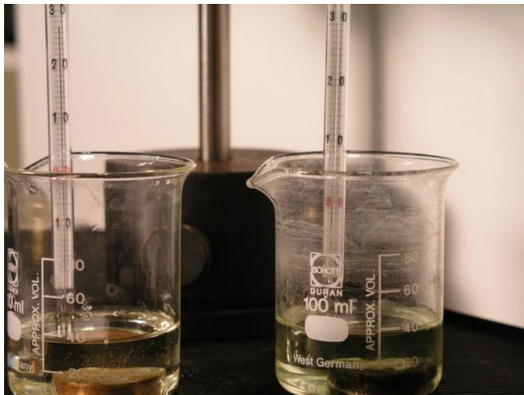
Abb. 2: Kupfer und Eisen nehmen bei gleicher Masse unterschiedlich viel Wärme auf.
