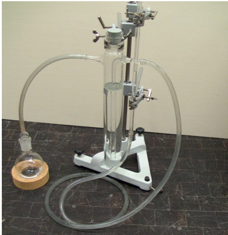
Abb. 2: Dampfdruck von Alkohol hebt eine Wassersäule.
