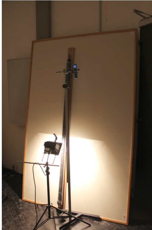
Abb. 5: Bestrahlung einer Heatpipe mit einer Halogenlampe
