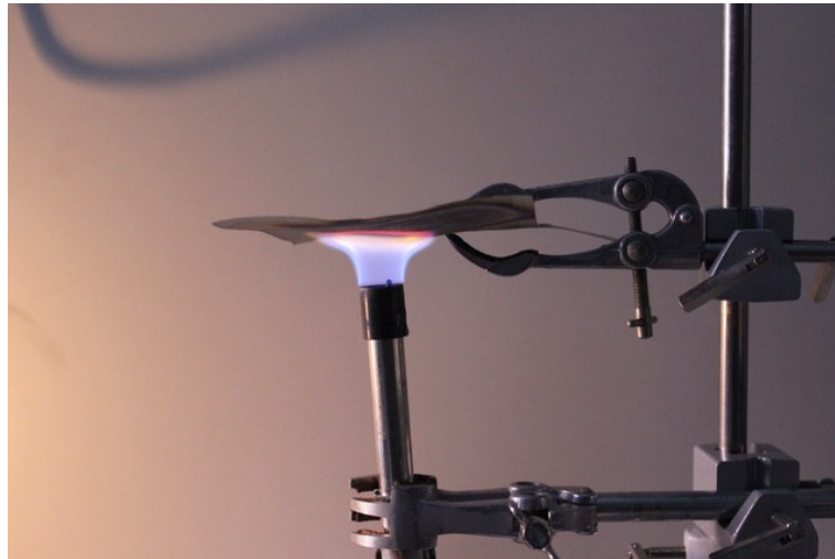
Abb. 1: Wärmeleitung verhindert das Brennen der Flamme oberhalb des Gitters.
