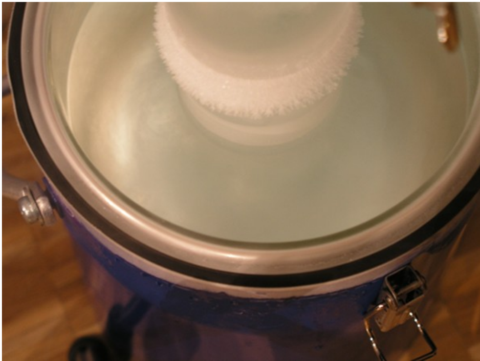
Abb. 2: In der Kühlfalle hat sich flüssiger Sauerstoff gesammelt, sichtbar durch ein bläuliches Schimmern.
