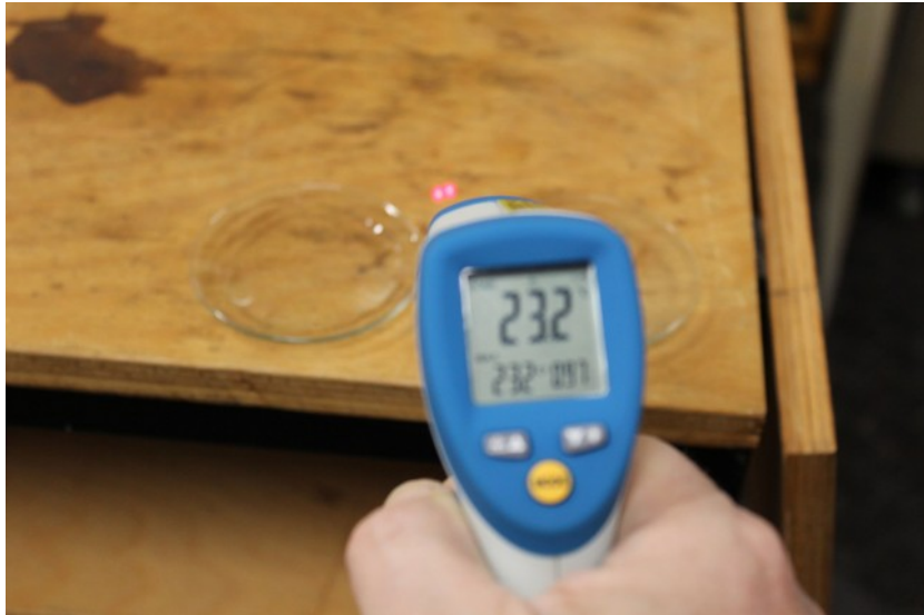
Abb. 1: Messung der Temperatur mit einem IR Strahlungsthermometer
