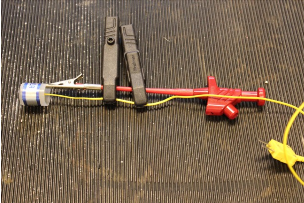
Abb. 1: Thermoelement (gelb) mit Halterung und kleinem Kunststoffbehälter
