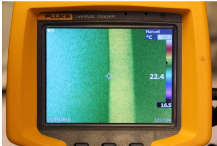
Abb. 1: Gespanntes Gummiband mit der Wärmebildkamera betrachtet.
