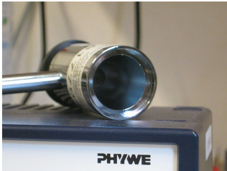
Abb. 1: Blick in das Messfenster einer Thermosäule.
