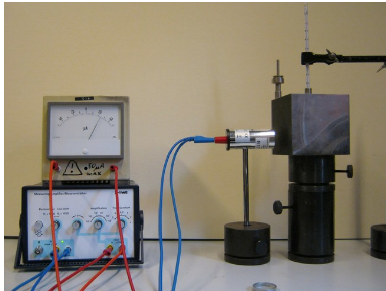
Abb. 2: Die Spannung der Thermosäule wird mit einem Messverstärker sichtbar gemacht
