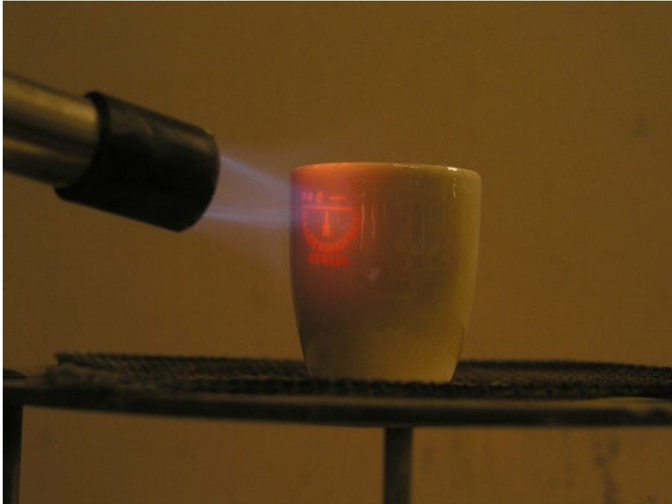
Abb. 6: Der Aufdruck im erhitzten Zustand
