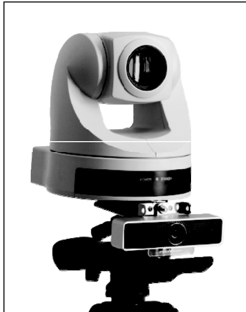
Abbildung 1: LectureSight-Kameraaufbau, oben Produktionskamera, unten Übersichtskamera (eigene Darstellung)
