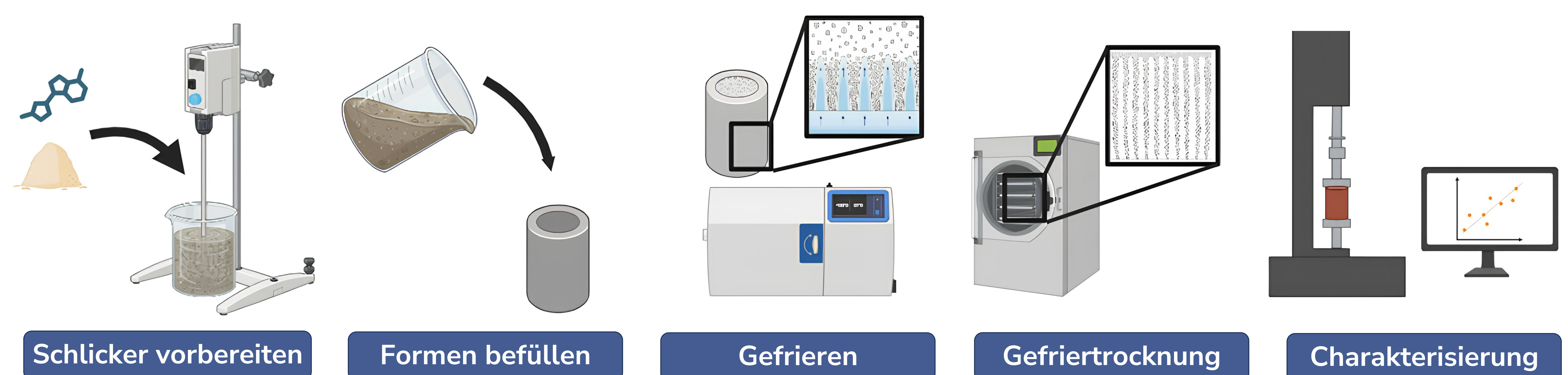
Prozessschema vom Freeze-Casting, Erstellt in https://BioRender.com
