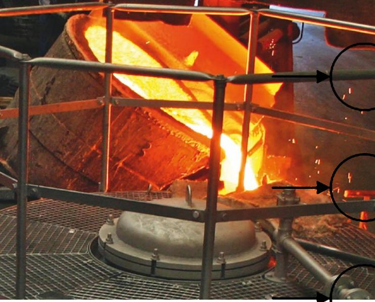
Der Gießereiprozess ist durch eine hohe Verkettung gekennzeichnet. Hier wird flüssiges Metall aus dem Schmelzbetrieb zum Abgießen der fertigen Form vorbereitet.
