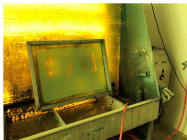
Abbildung 10: Belichtetes Sieb für den Siebdruck
