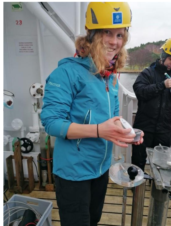
Für den zweiten Kurs haben wir Sedimentproben genommen. Hier schneide ich den Kern in 1-cm dicke Scheiben.
