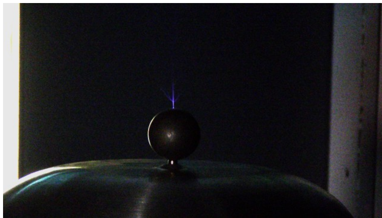
Abb. 5: Der Radius sollte nicht zu klein werden, dann finden die Entladungen zu früh statt und sind nicht mehr so Eindrucksvoll.
