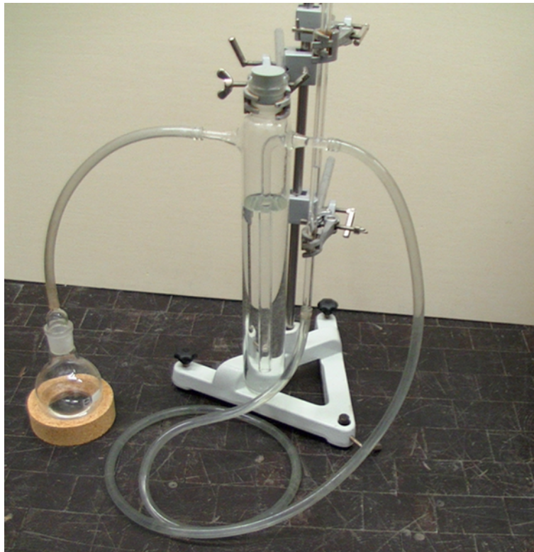
Abb. 2: Dampfdruck von Alkohol hebt eine Wassersäule.
