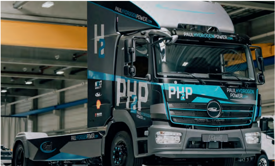
Bei diesem Fahrzeug handelt es sich um einen Paul Hydrogen Power E-Truck, basierend auf einem konventionellen Atego Giderchassis von Daimler Truck, der aktuell mit dem Voith Electrical Drive System aufgebaut wird. Die ersten 25 Fahrzeuge werden noch in diesem Jahr bei Paul Nutzfahrzeuge in Vilshofen produziert.
